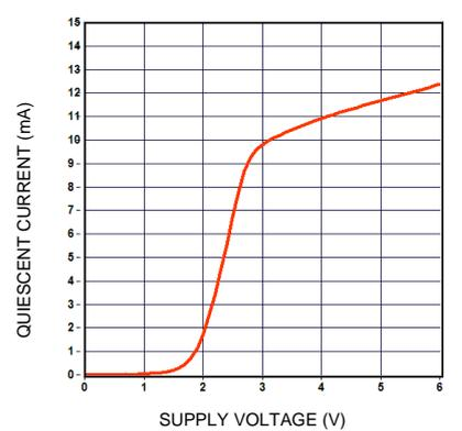
靜態電流 VS. 供給電壓
