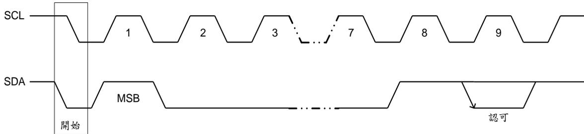
這個已被定址的設備在收到每一位元組(BYTE)後，即產生一“認可”的動作；否則在第九個時脈(CLOCK)的時間內SDA將會一直保持著高準位狀態。
