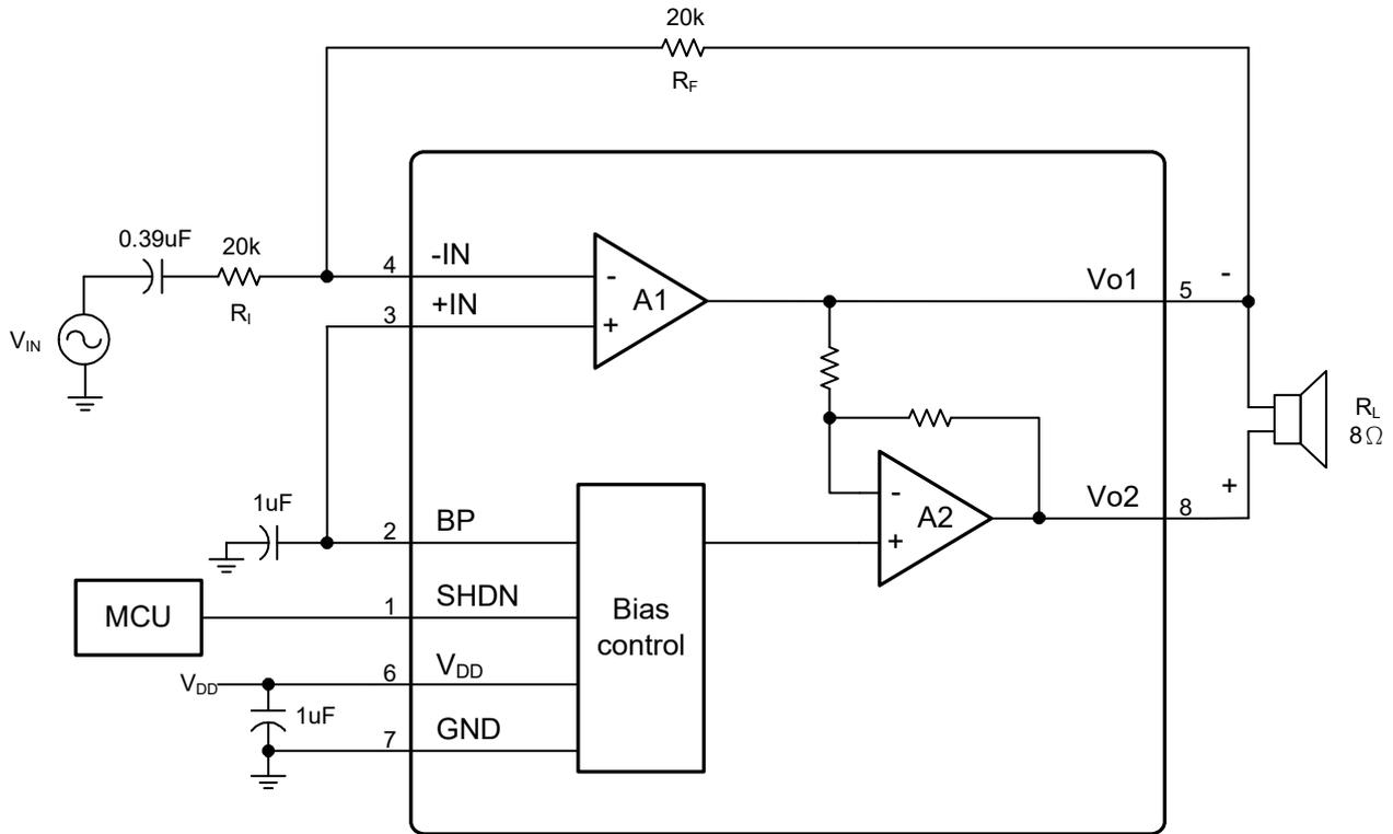
图一 音频放大器应用电路
